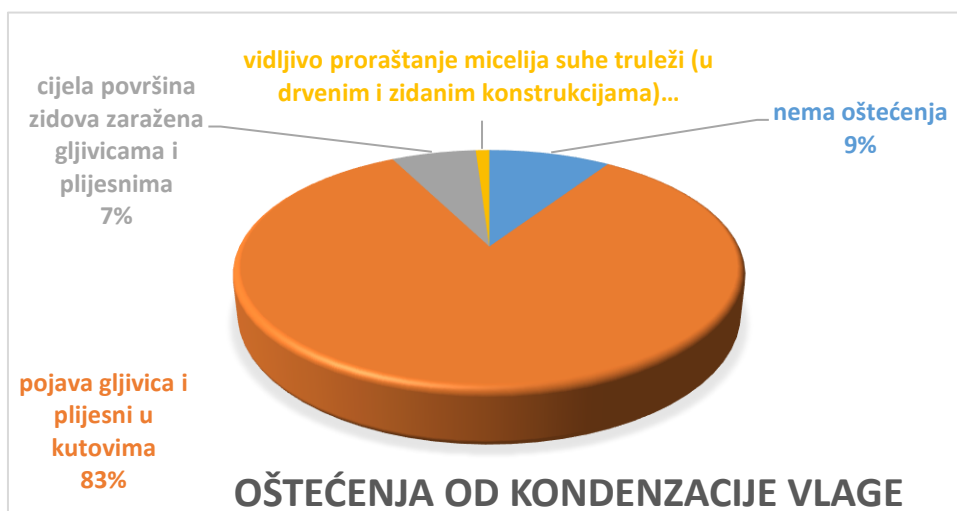
Slika 4-8. Raspodjela zgrada prema oštećenjima od kondenzacija vlage
