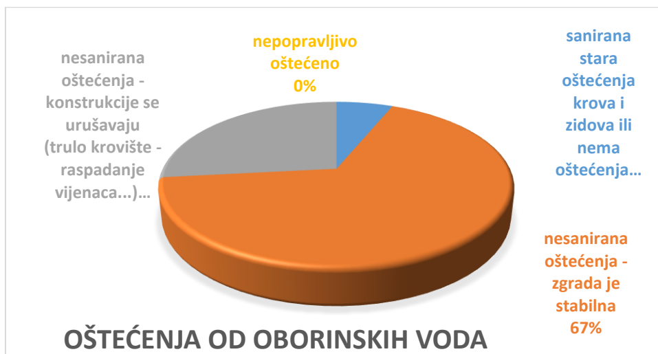
Slika 4-6. Raspodjela zgrada prema oštećenjima od oborinskih voda
